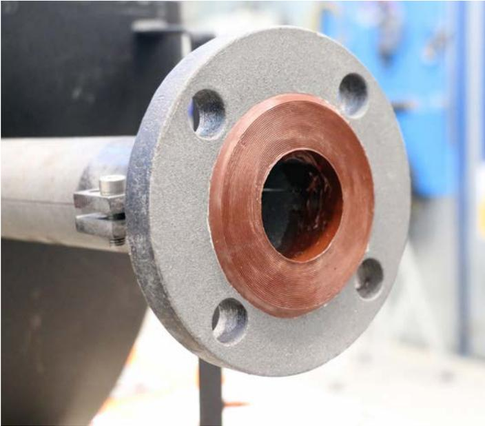
Belzona 4301 (Magma CR1 Hi-Build) ist ein pastöses Hochleistungssystem mit hervorragender chemischer Beständigkeit gegenüber einer Vielzahl von Chemikalien, insbesondere konzentrierten anorganischen Säuren und Basen.
