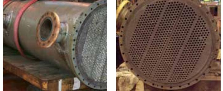
Durch starke galvanische und Lochfraßkorrosion beschädigter Rohrwärmetauscherboden Aufarbeitung mit Belzona 1511 vor dem Aufbringen einer Belzona-Hochtemperaturbeschichtung
