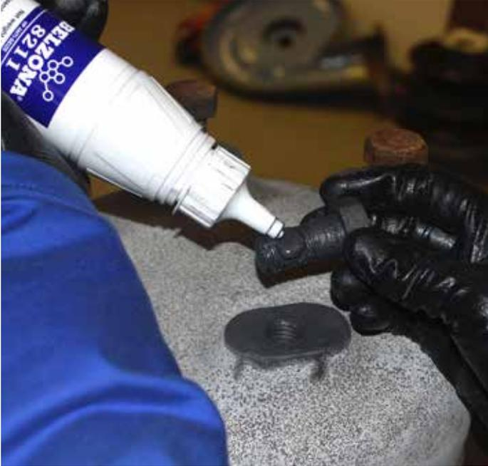
Belzona 8211 (HP Anti-Seize) ist eine leistungsstarke Behandlung zur Verhinderung des Festfressens und Aneinanderreibens von Gegenständen, die hohen Temperaturen, Korrosion, Chemikalien und mechanischen Verriegelungen ausgesetzt sind.
