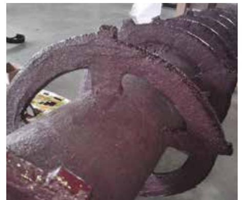
Mit Belzona 1811 beschichteter Schneckenbohrer
