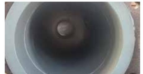
Die hellen Farben von Belzona 1523 ermöglichen eine einfache Sichtprüfung in Behältern.
