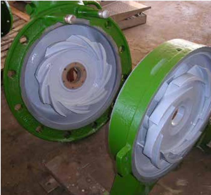
Belzona 1341 (Supermetalgilde) ist ein Zweikomponenten-Beschichtungssystem, das den Wirkungsgrad von Durchflusssystemen verbessert und Metalle vor den Auswirkungen von Erosion/Korrosion schützt.
