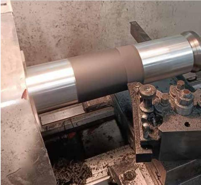
Belzona 1131 (Bearing Metal) ist ein pastöses Reparatursystem mit einem Feststoffanteil von 100 % und selbstschmierenden Eigenschaften, um reibungsarme Oberflächen zu erhalten, die nicht dauerhaftem Kontakt und geringer spezifischer Belastung ausgesetzt sind.
