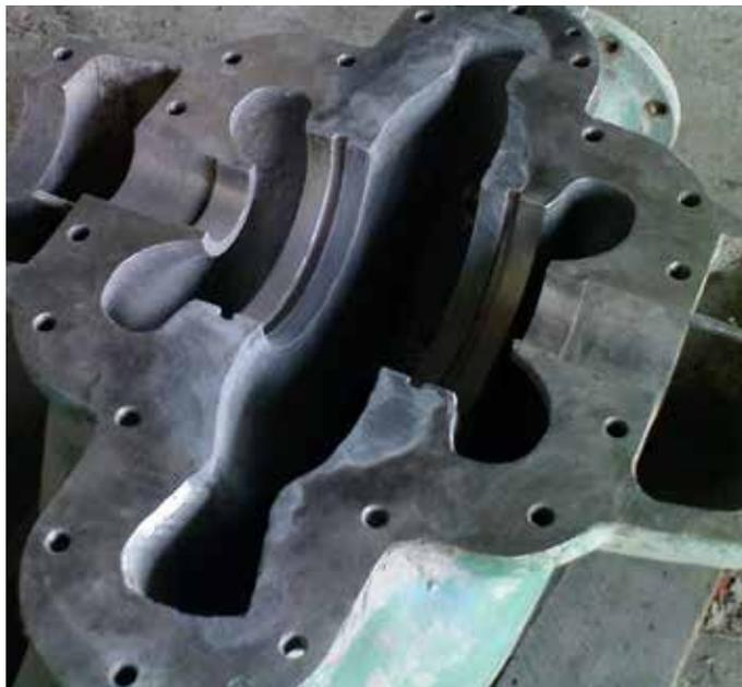
Belzona 1111 (Super Metal) ist ein kalt aushärtender Epoxidverbundwerkstoff mit einem Feststoffanteil von 100 %, der mit einer Siliziumstahllegierung verstärkt ist.
